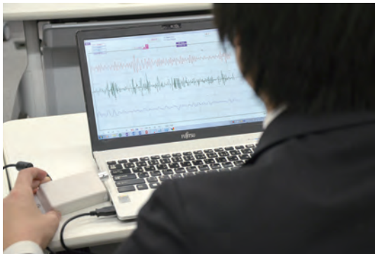
開発中のバイタルセンサー（写真左下、手元のデバイス）の作動状況。USBでパソコンにつなげば、心拍、体の動き、呼吸をモニターできる。
