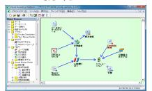
①アイコン操作に よる分析フローの 構築・編集
