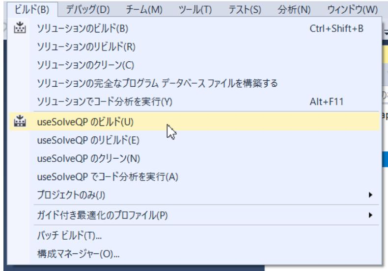
を選択すると useSolveQP.cpp がコンパイル、Nuorium Optimizer のライブラリとリンクされて、実行モジュールの useSolveQP.exe が作成されます。引数として knapsack.txt を与えるように「プロジェクト」→「プロパティ」→「構成プロパティ」→「デバッグ」の項目で、「コマンド引数」に「knapsack.txt」と入力します。
