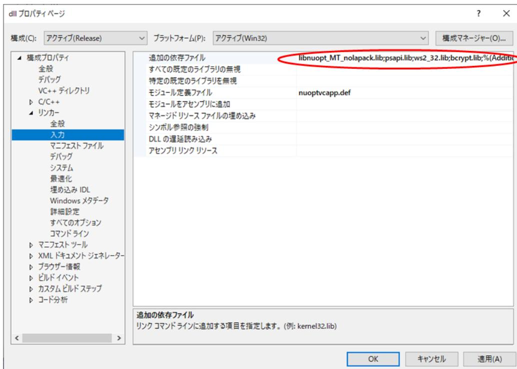
この後、ソリューションのビルドを行うと、以下のようなエラーメッセージが出力され正しくビルドが完了しません。これは外部 CLAPACK(CBLAS) の関数のリンクに失敗しているためです。そのため、以下で外部 CLAPACK(CBLAS) ライブラリの設定を行います。
