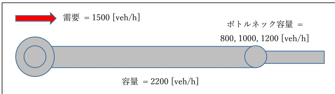
図 9 下流にボトルネックがある道路
