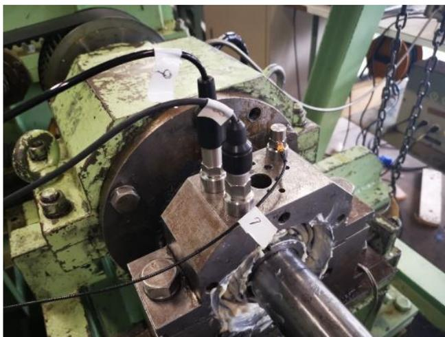
図2 実験装置とセンサーの位置
